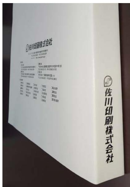
通常、インクジェットを使用する場合、本の厚みが変わると印字ヘッドと対象物の間隔も変化し、高品質の印字は難しかったのですが、このシステムでは個別設定した本の厚みデータにより搬送メカが自動追従しクリアランス調整をおこないます。
